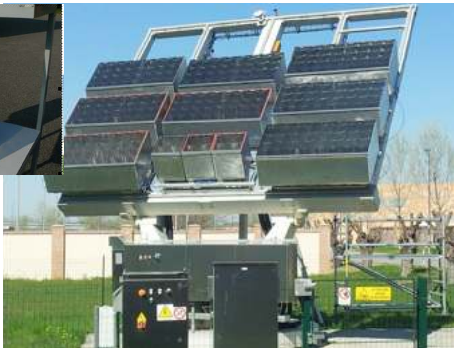
Figura 1b) Test facility per lo studio della tecnologia del fotovoltaico ad alta concentrazione installata presso la sede RSE di Piacenza
