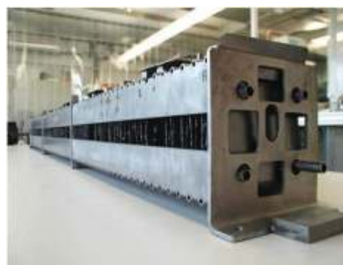
Scambiatore di calore per una unità di accumulo termico a cambio di fase, con alettature fatte con fogli di grafite, prima del caricamento del materiale a cambiamento di fase.
