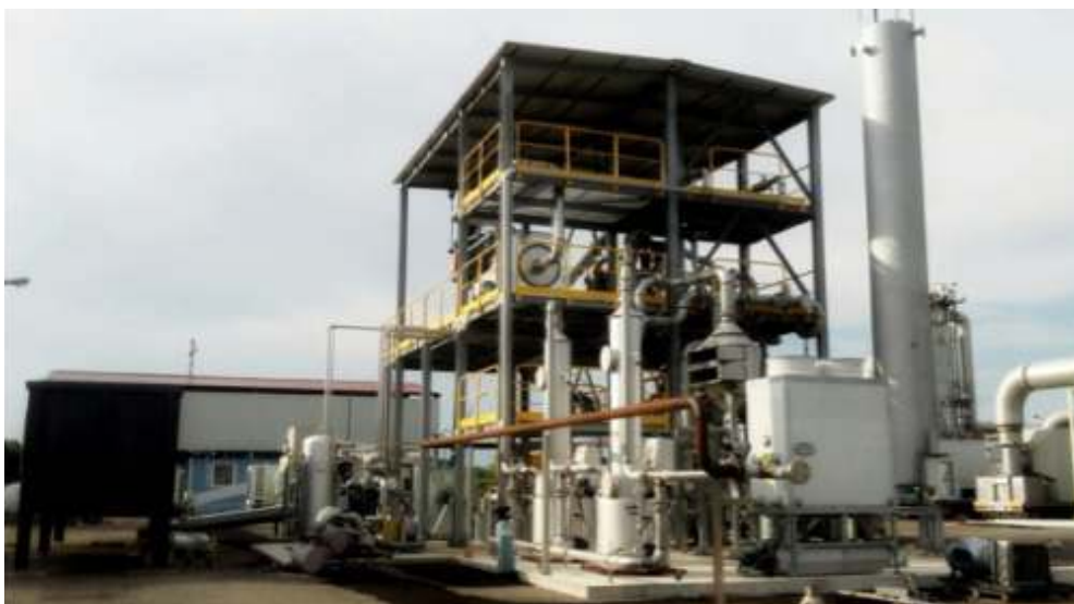
Gassificatore three stages – CR ENEA Trisaia
