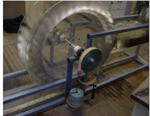
Modello in laboratorio di una ruota di fianco, alla Queen's University di Belfast
