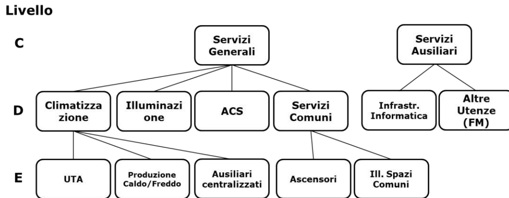
Figura 26 – Ripartizione del campione per consumo totale Schema usi finali elettrici tipici di un edificio per uffici
